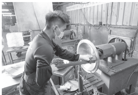
不鏽鋼鍋在壓模成型後以人工拋光，使其表面平整光滑。
